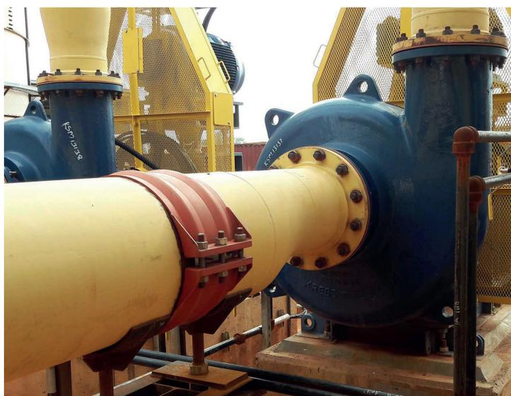
Насос millMAX-e – самый эффективный шламовый насос в своем классе, обеспечивающий экономию энергии и затрат за счет снижения общей стоимости владения. Высокоэффективная конструкция насоса зачастую позволяет использовать двигатели меньшего размера.
