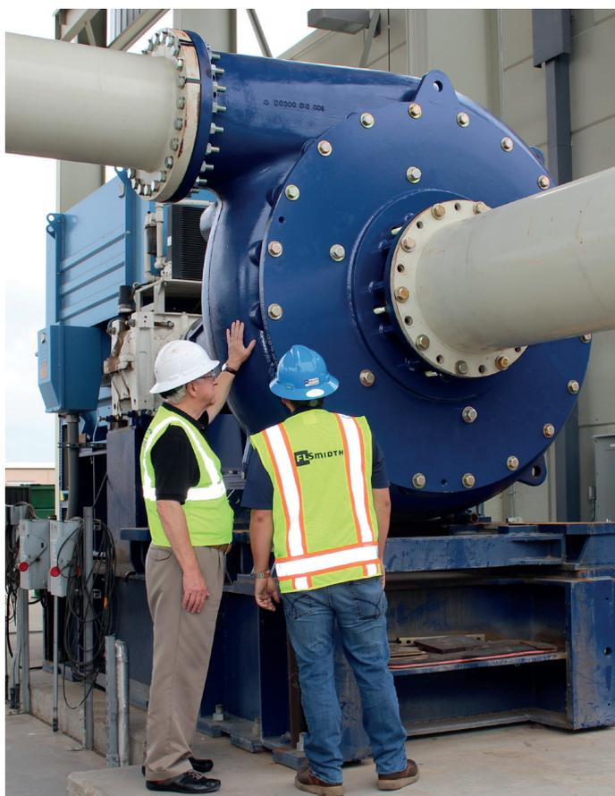
Горизонтальные насосы millMAX имеют запатентованную конструкцию регулировки изнашиваемого кольца на стороне всаса для уменьшения износа.
