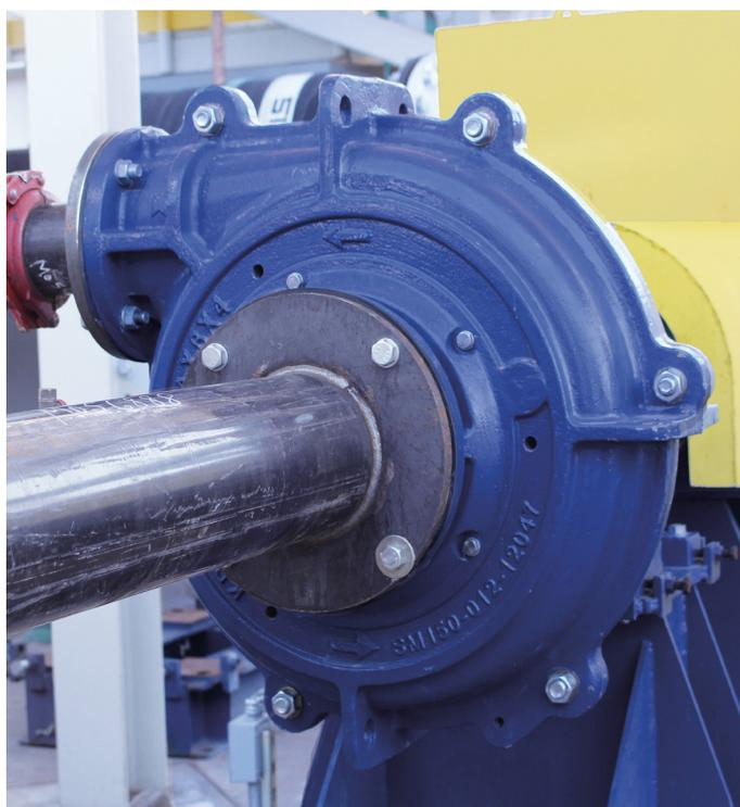
Насос с разъемным корпусом оснащен новейшим центробежным уплотнением и износостойким уплотнительным кольцом KREBS, что обеспечивает эффективное уплотнение на стороне всаса и высокую эффективность перекачки шлама.
