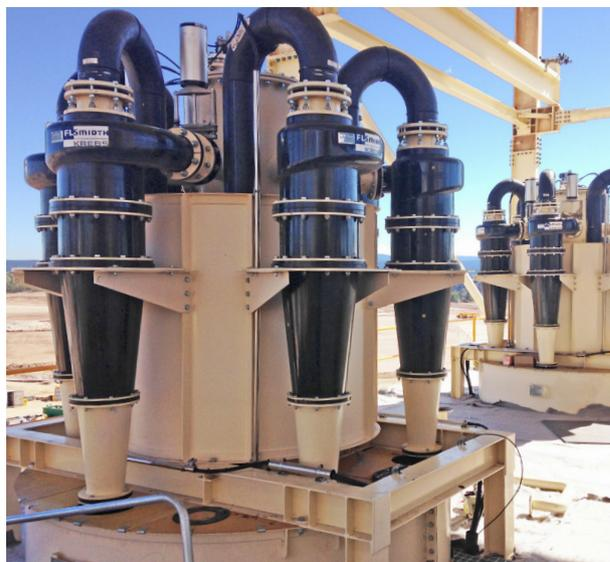
**Гидроциклоны gMAX поставляются в типоразмерах от 6 дюймов до 20 дюймов в диаметре**
