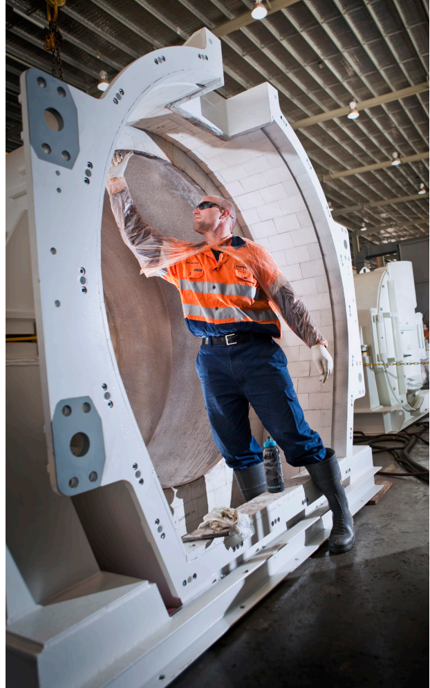
Aplicação de WEAR MAX® à carcaça da centrífuga
